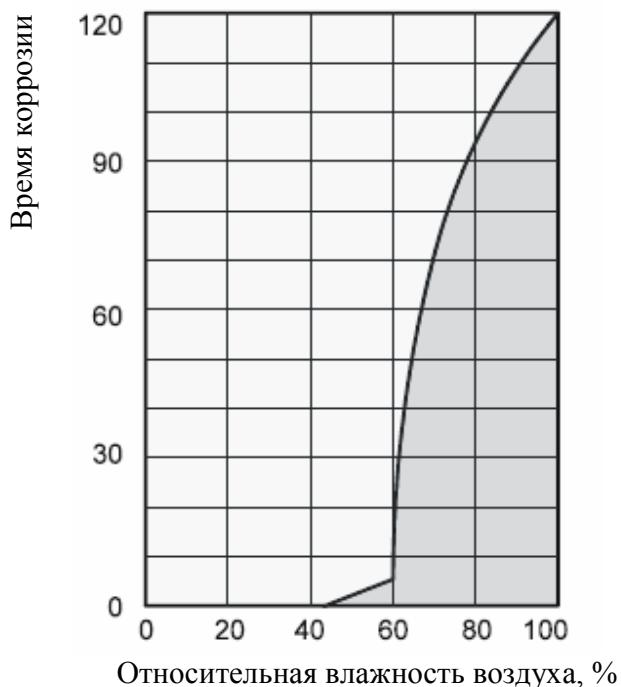
Как видите, скорость коррозии незначительна при относительной влажности воздуха менее 50 %, а при влажности воздуха менее 40 %, скоростью коррозии можно пренебречь. Но когда относительная влажность воздуха превышает 60 %, скорость коррозии значительно увеличивается. Данный пример повреждения, вызванного влажностью, также применим для многих других материалов, таких как порошкообразные вещества, упаковочных материалов, древесина, и электронные устройства.
